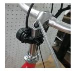
ALIGHN MAKING SURE INSERTION SAFETY MARK IS OBSERVED.TIGHTEN WITH 6mm ALLEN KEY
