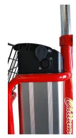
YOU MAY REMOVE BATTERY FOR CHARGING IF REQUIRED BY TILTING SEAT FORWARD (LEVER UNDERSEAT MAY BE INITALLY STIFF) FIRSTLY MAKE SURE POWER IS TURNED OFF USE ON/OFF KEY ITO RELEASE BATTERY LOCK.SLIDE BATTERY UPWARDS . INSTALATION IS SIMPLY THE REVERSE
